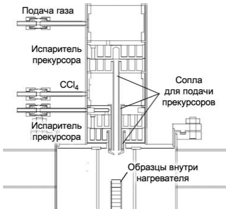
Рис.3. Схема подачи прекурсоров в реакторный блок с испарителями и соплами для подачи прекурсоров в реакционную камеру.
